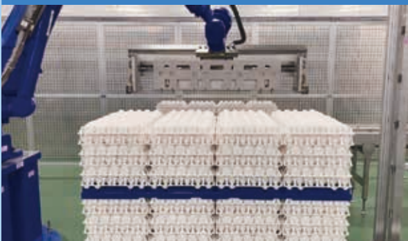
機器手臂夾盤作業，取代以往人力落盤
