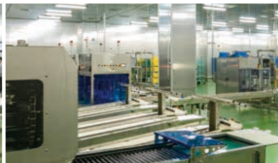
篩選出的好子蛋，根據客戶需求，落入分級軌道，及疊盤機進行盒蛋包裝
