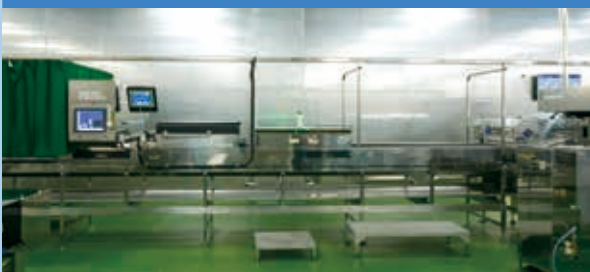
篩子偵測設備、裂紋偵測設備、紫外線殺菌機、重量分級
